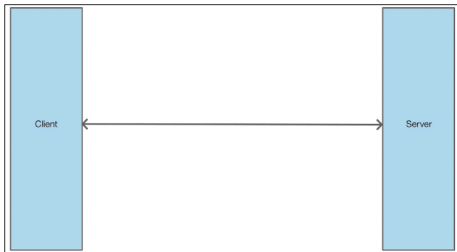
WebSocket-API: Bidirektionale Verbindung zwischen Client und Server (Bild 3)
